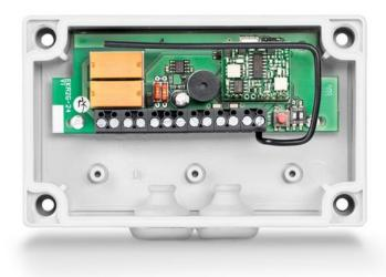
Módulo receptor para el accionamiento de las puertas automáticas y los motores para ventana con 24 V DC
