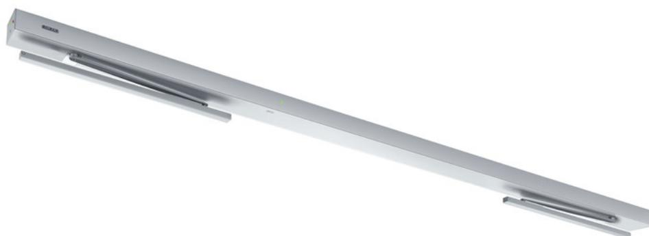
Sistema electromecánico de puerta batiente para puertas cortafuegos de doble hoja con regulación de la secuencia de cierre y sensor de humo integrado
