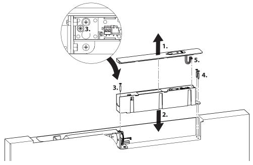
► Conectar el cable del encoder de la unidad motor-engranaje.
