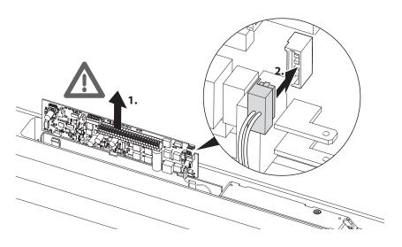
► Conectar el cable de 24 V de la unidad motor-engranaje.
