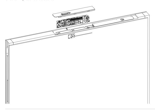
Enganchar con los dedos o la herramienta (desenclavar) y levantar cuidadosamente la placa de control
