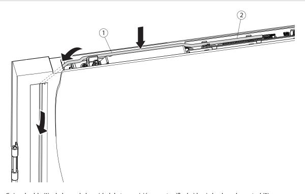
Guiar el cable (1) a lo largo de la unidad de transmisión y motor (flecha) hacia la placa de control (2).
