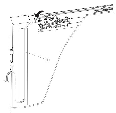
Continuar guiando el cable (4) a través de la hoja de puerta y el paso de cables.
